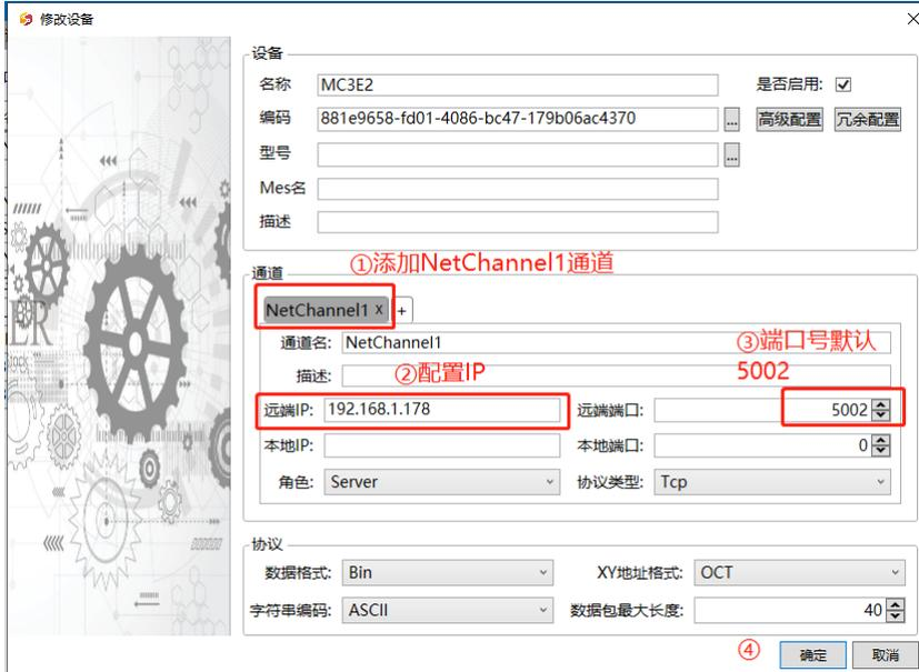
通道选择 NetChannel，远端 IP、远端口（具体 IP 和端口要根据实际端口而定），其他配置选择默认，如上图。
