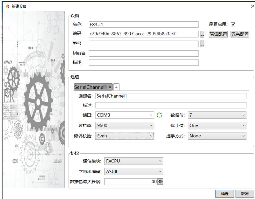
步骤：通道选择 SerialChannel，端口选择 COM3（具体端口要根据实际端口而定），数据位选择 7，奇偶校验选择 Even，通讯模块选择 FXCPU，其他配置选择默认，如上图。
