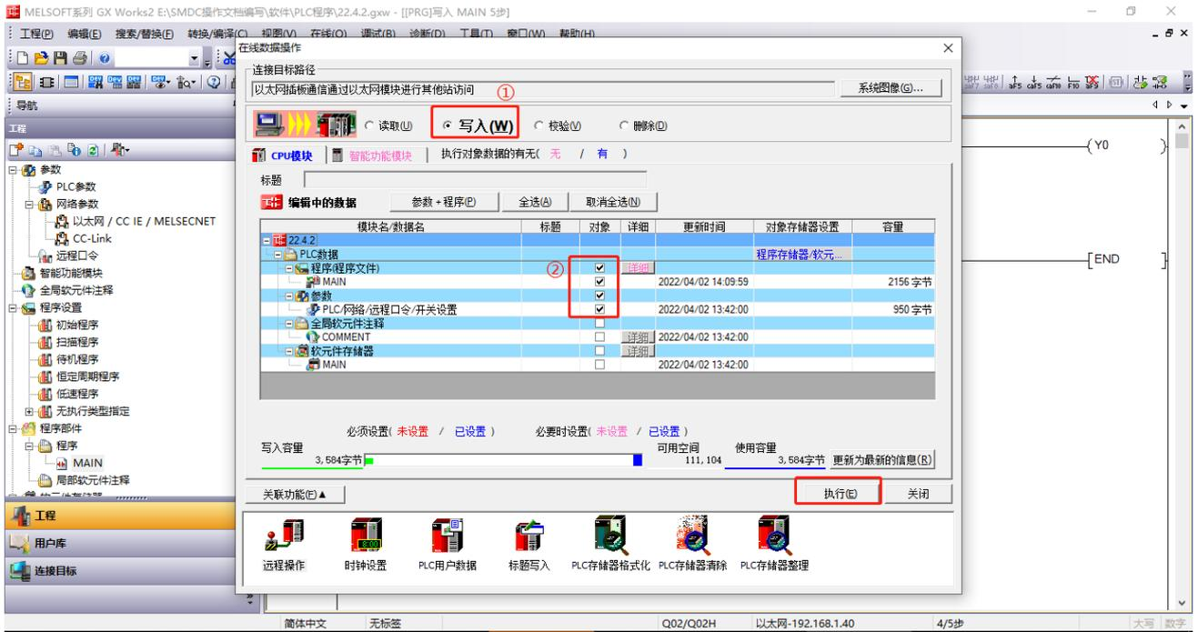
9、修改后的参数写入 PLC 后，PLC 需要断电重启生效。可以通过 PING 命令测试 PLC 的 IP 地址是否能 ping 通，以及 GXwork2 软件中连接目标设置是否可以通，下图所示：
