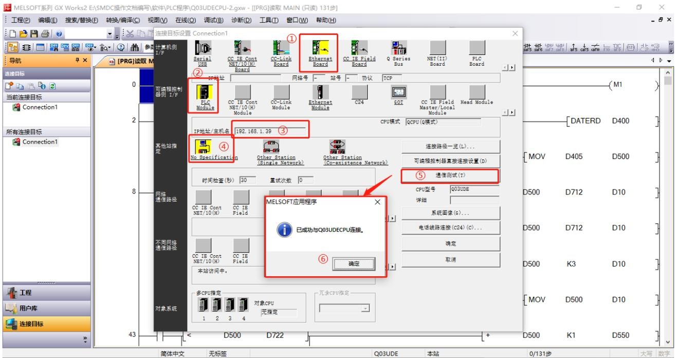
PLC 配置成功，此时三菱 Q03UDECPU 已经具备跟 SMDC 通讯的基础条件。
