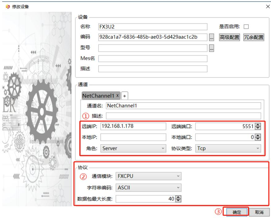
通道选择 NetChannel，远端 IP、远端口（具体 IP 和端口要根据实际端口而定），通讯模块选择 FXCPU，其他配置选择默认，如上图。
