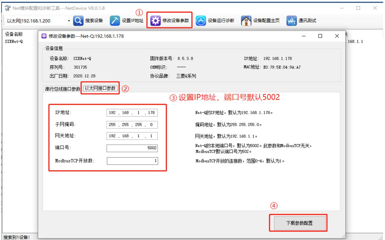
SIENet-Q 系列通讯模块配置完成, 以具备跟 PLC 的通讯基础。
