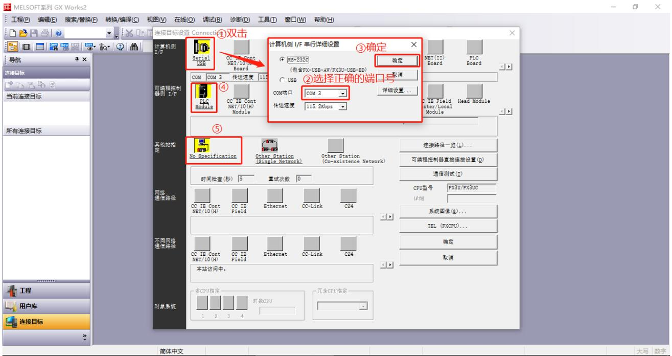
3、完成上述步骤后，点击【通信测试】，连接成功如下图所示，点击【确定】
